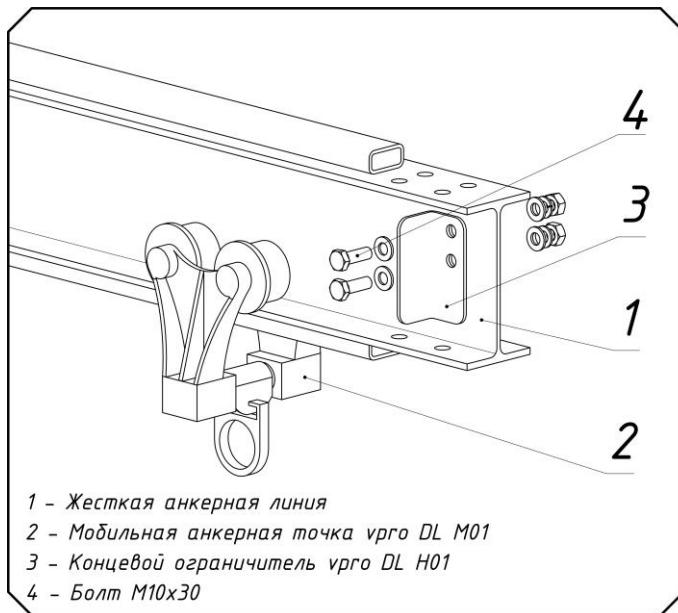
Рис. 6 Монтаж мобильной анкерной точки и концевого ограничителя.
