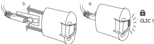
Clipping/unclipping the lamp / Clippage & déclippage du boîtier lampe
