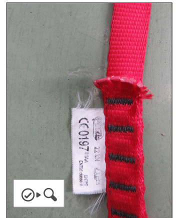
• Стропа с вылезшими волокнами
