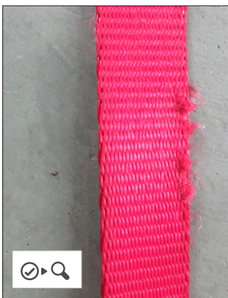
• Стропа с вылезшими волокнами
