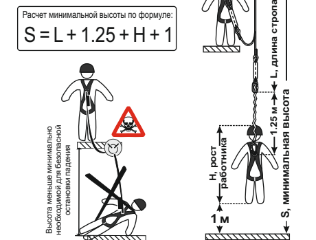
Рис. 9. Использование стропов без амортизатора
