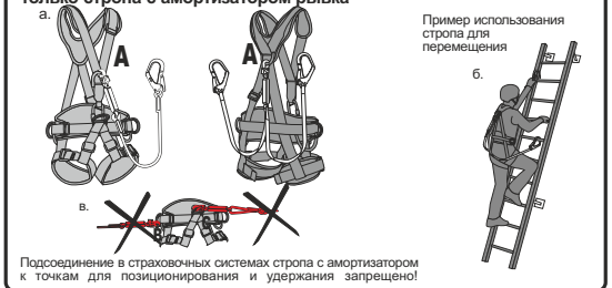
Рис. 6. Использование карabiнов, входящих в состав стропов
