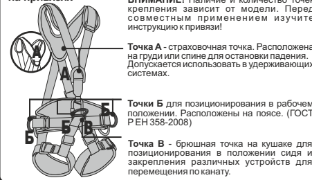
Рис. 5. Способы крепления к анкерным устройствам
